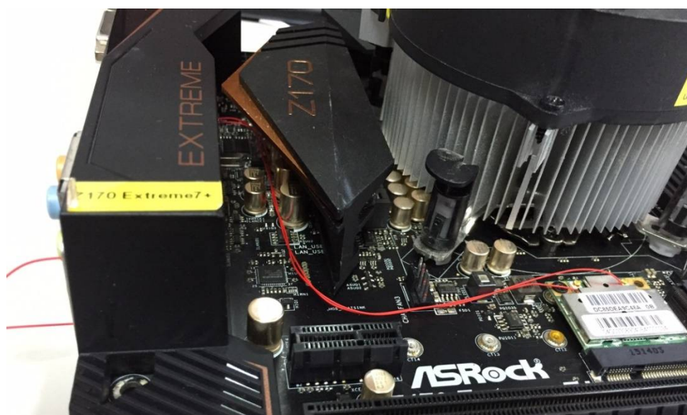
Стъпка 3 – Инсталирайте IO капак отново на Z170 Extreme7 + както на снимката по-долу.
