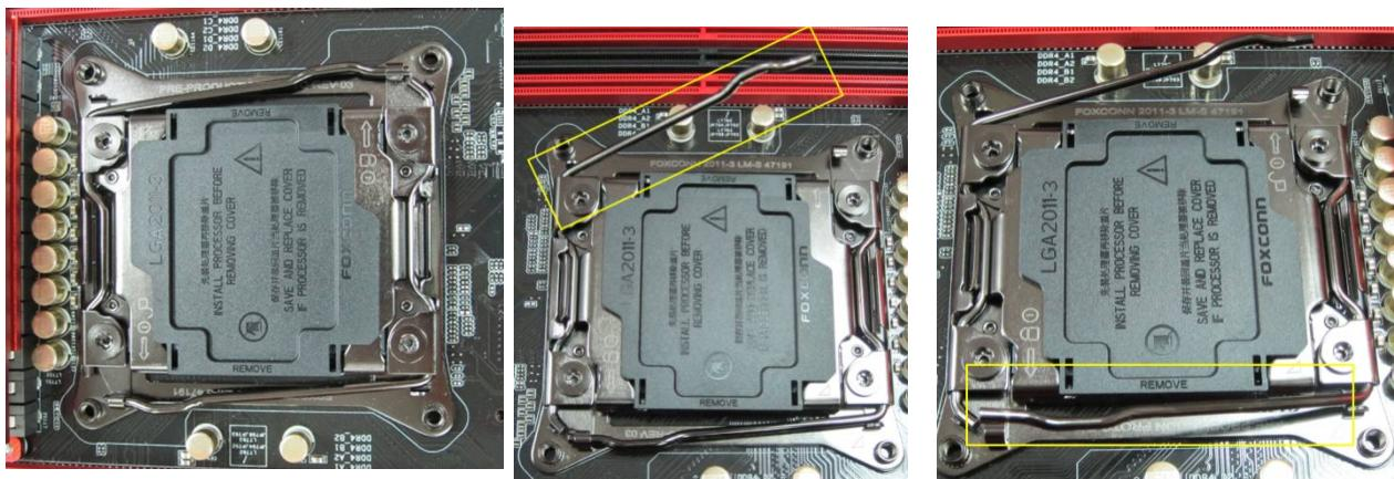
**Βήμα 2. Εισάγετε το LGA 2011-3 CPU:** Βρείτε το Pin1 και τις δύο εγκοπές, προσανατολίστε τον επεξεργαστή και ύστερα τοποθετήστε τον στο socket.
