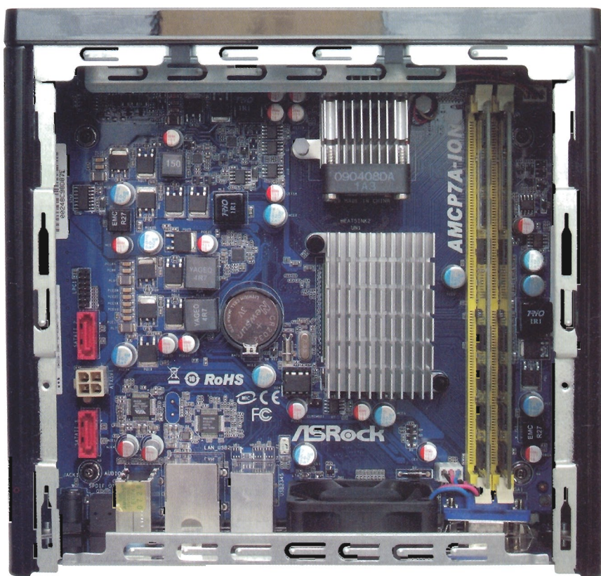
▲ASRock NetTop主機板全數採用日系固態電容，藉此提升產品壽命與穩定性
