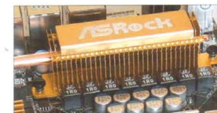
Komponen yang disertakan di Asrock justru menghalangi kemungkinan untuk penggunaan extreme cooling jenis tertentu.
