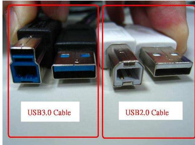
Si Ud. conecta un cable USB 2.0 a un HDD externo con USB3.0 como lo de abajo, el dispositivo no funcionará al modo SuperSpeed.
