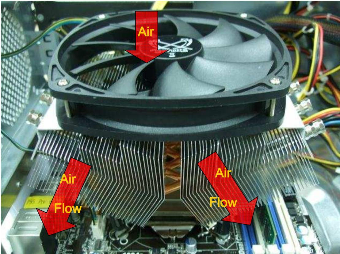
4. Con el refrigerador Thermaltake Spin Q CPU.
