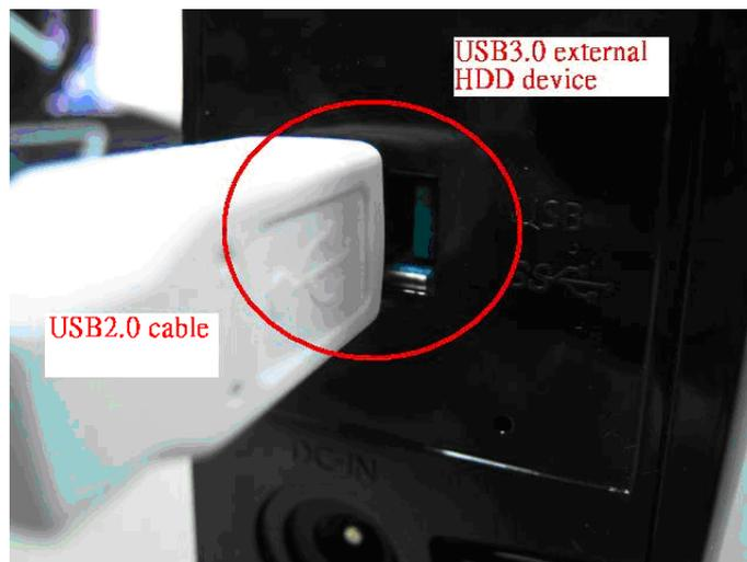
Por favor conecte un cable USB3.0 a un HDD externo con USB3.0 para que el dispositivo funcione al modo SuperSpeed.
