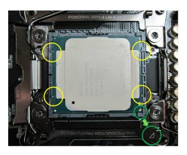
**手順 3. ソケットを閉じます:** 両側にあるレバーを押し下げて、固定タブの下に固定します。保護カバーは自動的に剥がれます。
