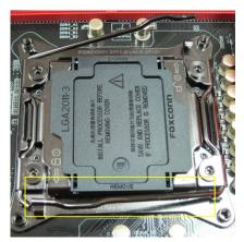
手順 2. **LGA 2011-3 CPU を挿入します:** Pin1 と 2 つの方向決めキーノッチの位置を確認して、**CPU** をソケットの中に丁寧に入れます。
