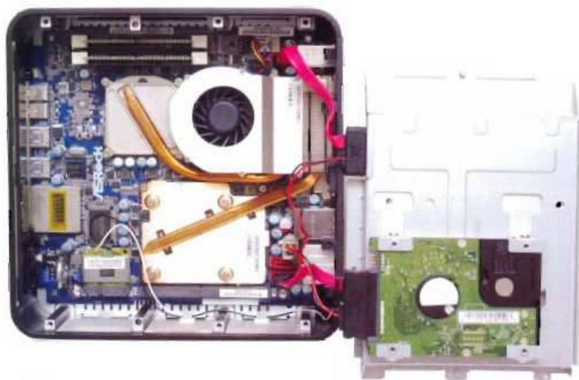
▲ASRock Vision 3D使用特殊規格的自製主機板，內含日系固態電容、薄型電感等高檔元件，單一鼓風扇散熱架構運作時相當安靜。
