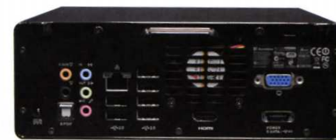
▲除了HDMI數位影音和7.1聲道輸出外，還追加了1個Powered eSATA/USB埠
