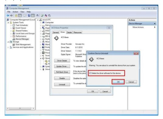
Después de desinstalar el controlador de ACS-6xxxx y reiniciar el sistema, el controlador LAN funcionará con normalidad.
