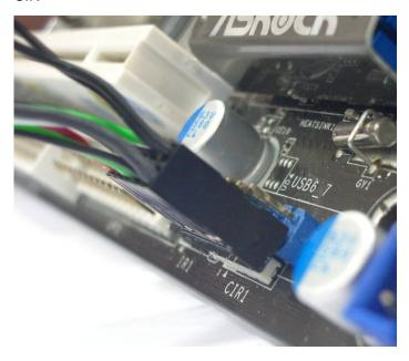
Paso 2: Por favor conecte el receptor CIR al panel frontal USB antes de arrancar el sistema.
