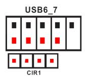
En la siguiente figura se muestra la conexión correcta del cable del panel frontal USB con la base de conexiones CIR
